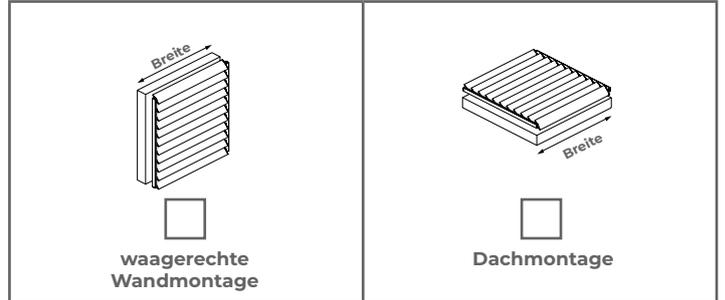
**Das System SUNBREAKER 210 kann in einer Nische oder auf einer Unterkonstruktion montiert werden. ES GIBT KEINE HALTER ZUR FASSADENMONTAGE!!!**
